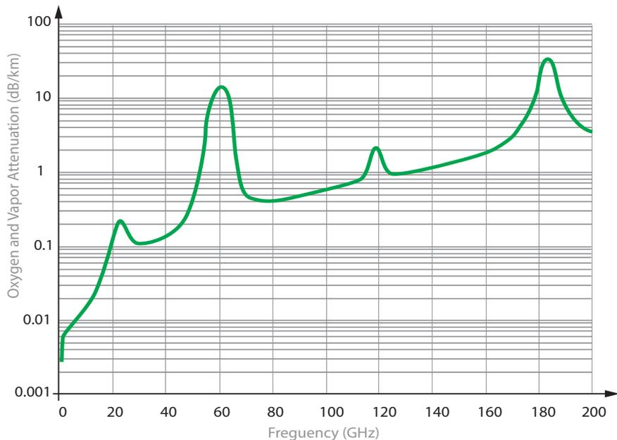
Как видно из графика, один из максимумов поглощения приходится как раз на диапазон 60 ГГц, поэтому оборудование V-band используют на дальностях до 1 км. В диапазонах 70-80 ГГц мы имеем «окно прозрачности», что позволяет достигать дальности до 15 км для климатического региона Е. При расчетах дальности и доступности радиоканала необходимо учитывать климатический регион – то есть усредненное по году количество всевозможных осадков – дождя, тумана, снега, града.
