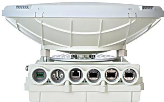
Модель с максимальной совокупной скоростью 1000 Мбит/с TDD наращивается с помощью лицензии; по умолчанию, данная модель отгружается с лицензией на 100 Мбит/с. Модель имеет 2 гигабитных комбо-порта медь/оптика и универсальную систему питания, позволяющую запитывать устройство через PoE-инжектор или от коммутатора 802.3at, а также локально от 48 В-источника питания.
