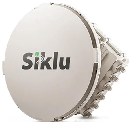
Модель FDD с максимальной скоростью 2000 Мбит/с. EH-2200F предназначена для операторов связи, на неё можно установить лицензии на любую описанную выше функциональность и скорость; по умолчанию на устройстве открыта скорость 100 Мбит/с. Главное отличие модели 2500 – высокая мощность, позволяющая достигать дальностей 15 км с хорошей доступностью.
