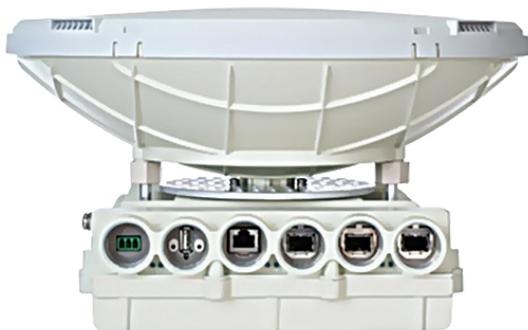
Самая простая модель с максимальной совокупной скоростью в 700 Мбит/с. Модель имеет 2 гигабитных комбо-порта медь/оптика и универсальную систему питания, позволяющую запитывать устройство через PoE-инжектор или от коммутатора 802.3at, а также локально от 48 В источника питания.
