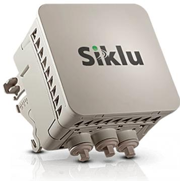
Модель диапазона 60 ГГц TDD с максимальной совокупной скоростью 200 Мбит/с, по умолчанию отгружается с лицензией на 100 Мбит/с. Предназначен для тех кому нужна «труба» с хорошей скоростью. Рекомендуемая дальность для модели EH-500TX – до 500м. Основное достоинство – компактность и низкая цена, 2 порта PoE out для питания камер видеонаблюдения или точек доступа WiFi. Это самая доступная по цене модель Siklu.
